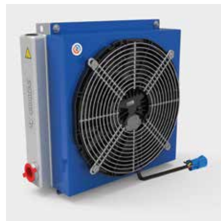
Breites Portfolio: Die Kühler der Serie EBR mit bürstenlosen 24V Lüfter der Schutzart IP68 und PWM-Ansteuerung sind bestens für die Elektromobilität geeignet
